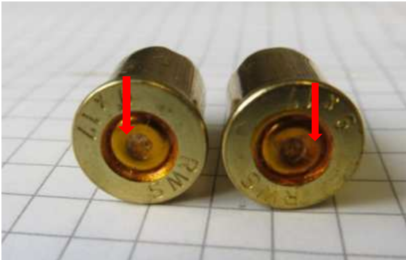
Bild 13: Kartuschen, keine Zündung durch den Schlagbolzen
