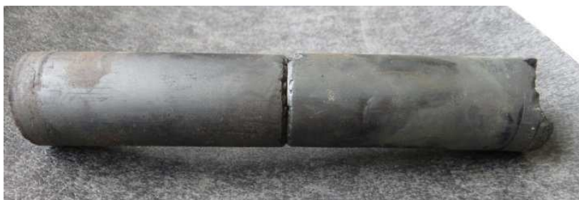
Bild 32: halbierter Gummipuffer, Ausfransungen am rechten Ende
