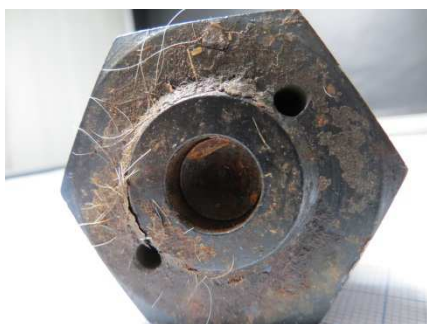
Bilder 25 und 26: Beispiele für mangelhafte Reinigung und Wartung
