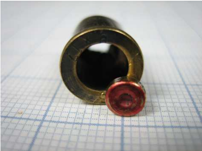
Bild 18: Treibkartusche, ausgestanzter Boden
