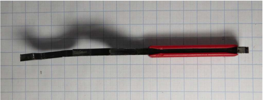
Bild 29: Auslösehebel verbogen, kein kontrolliertes Auslösen des Schusses möglich
