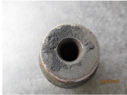
Bilder 27 und 28: Verschmutzung durch eingebrannte Pulverrückstände
