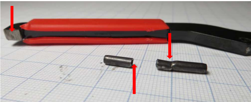
Bild 30: gebrochener Stift und abgeschliffene Auszieherkralle
