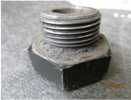
Bilder 27 und 28: Verschmutzung durch eingebrannte Pulverrückstände
