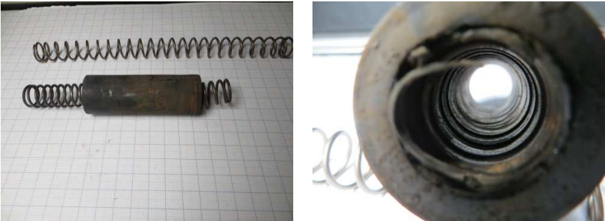
Bilder 21 und 22: stark verkürzte Schussbolzenfeder und deren Auswirkung auf den Gummipuffer
