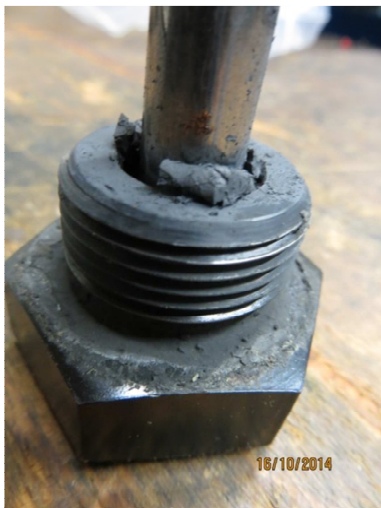
Bild 20: Fragmente des Gummipuffers sind mit dem Schussbolzen und in der Verschlussmutter verklebt.
