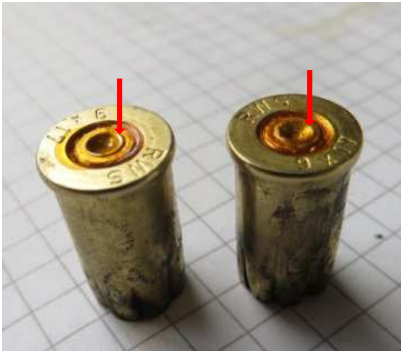
Bild 14: gleiche Kartuschen (wie Bild 13) mit korrekter Zündung
