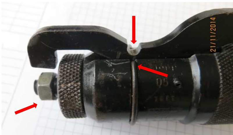
Bild 31: Manipulation am Schlagbolzen (Kopfstückmutter) und zusätzlich ausgehängte Ringfeder
